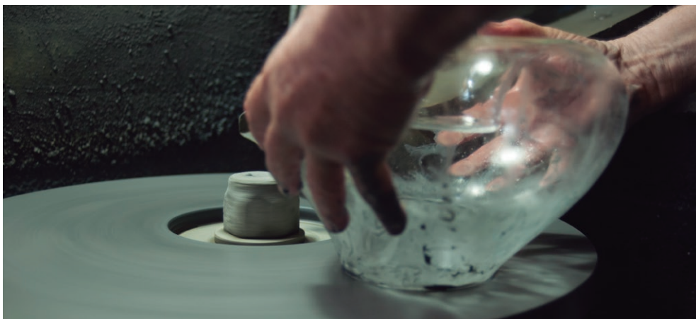
Lijado de la pieza. Ponçage de la pièce.
