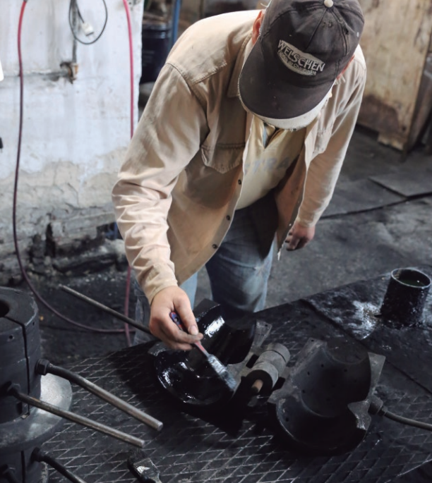
Preparación de los moldes para el soplado. Préparation des moules pour le soufflage.
