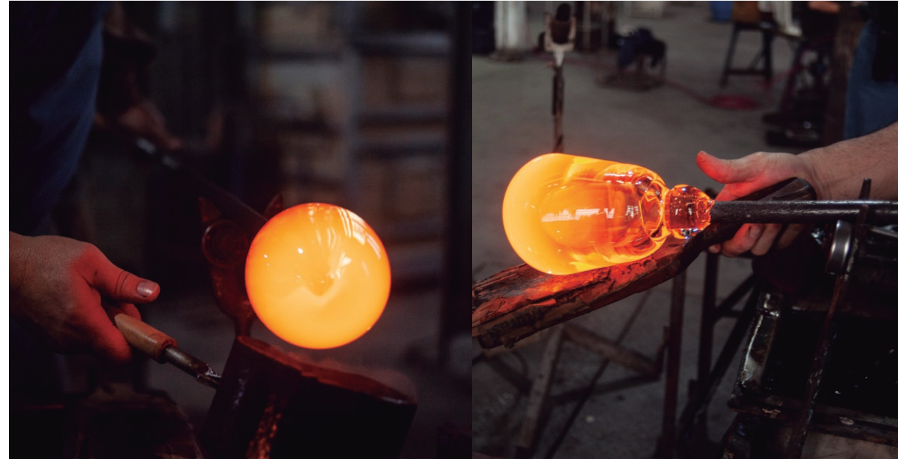
Primer soplado: preparación de la burbuja de vidrio. Premier soufflage : préparation de la bulle de verre.
