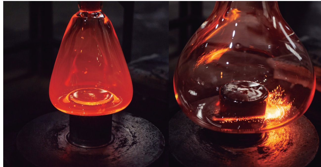
Primer experimento: soplado libre sobre un cilindro metálico. Première expérimentation : soufflage libre sur un cylindre métallique.
